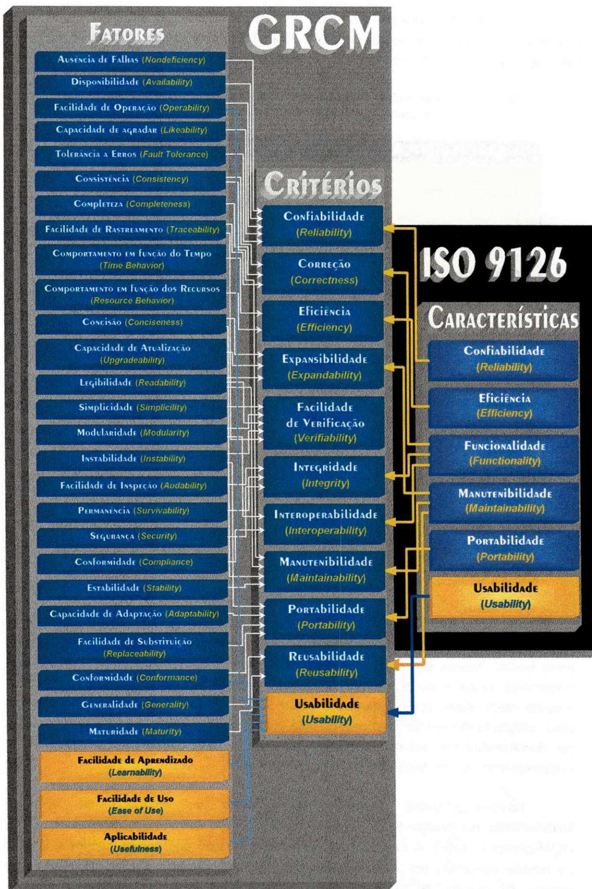
Fig. 5 – Critérios e fatores do modelo Síntese do SQM (ou GRCM) [Terv96] e comparação dos critérios do GRCM com as características do padrão ISO 9126 [ISO92].
