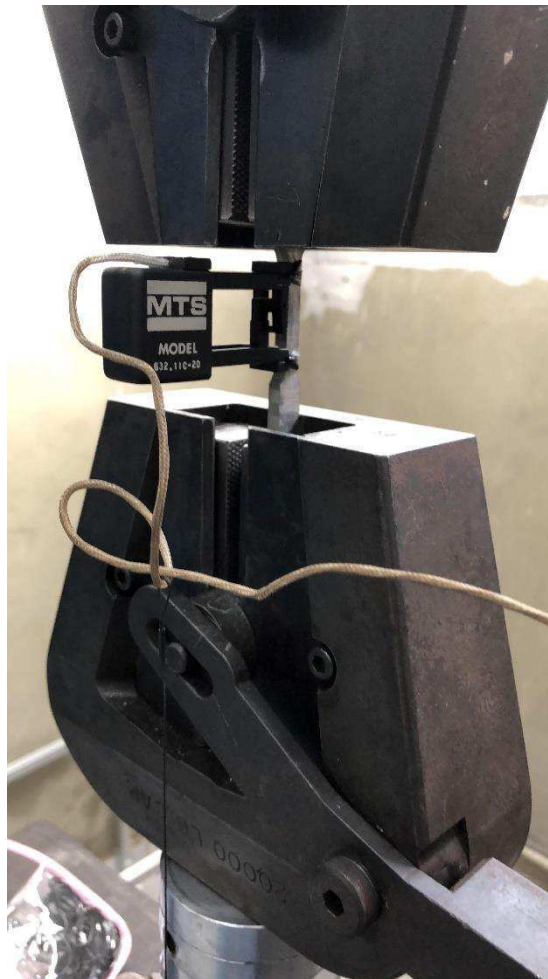
Figura 20: Máquina universal de ensaios MTS, modelo 810, adaptada para tração uniaxial.
