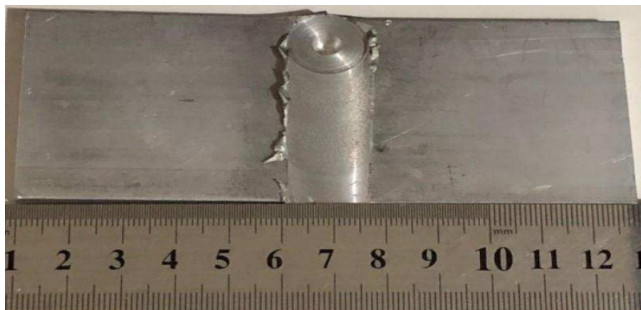
Figura 8: Defeito de superfície - excesso de rebarba.
