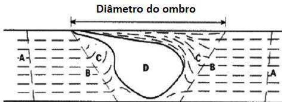
Figura 4: Esquema da seção transversal de uma soldagem FSW, ilustrando as diferentes zonas: (A) Metal Base, (B) Zona Termicamente Afetada, (C) Zona Termomecanicamente afetada, (D) Zona Misturada.
