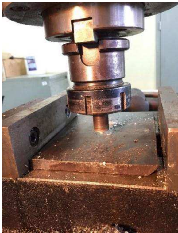
Figura 19: Fresadora universal automática modelo FU-300 da Diplomat com a ferramenta de pino rosqueado cilíndrico de ponta arredondada conectado.
