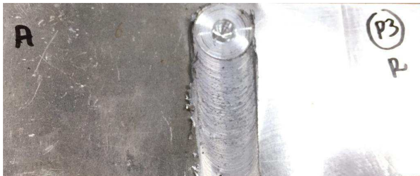
Figura 16: Junta de alumínio com a liga AA 5083-O no lado de avanço (A) e a liga AA 7075-T651 no lado de recuo (R).
