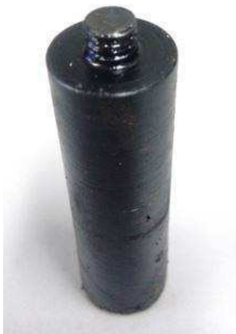
Figura 18: Ferramenta de Soldagem de pino rosqueado cilíndrico de ponta arredondada.
