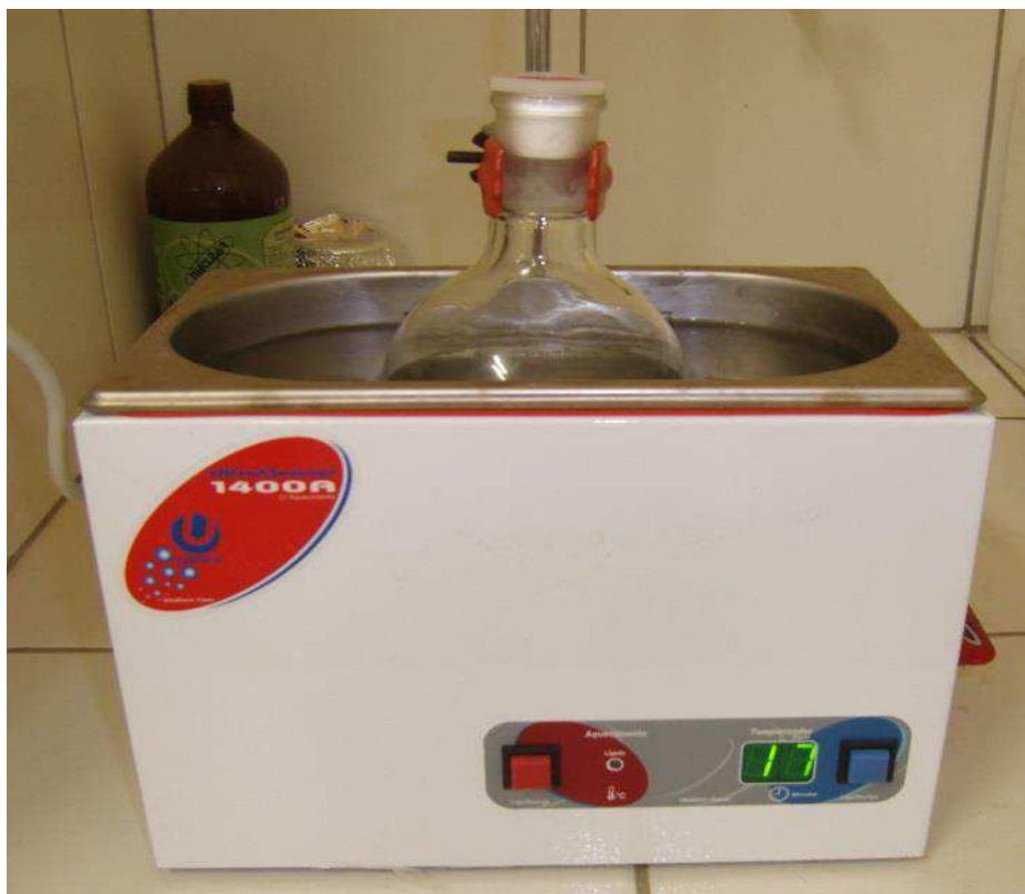
Figura 13. Utilização do ultrassom na síntese do tri- O -acetil-D-glucal
