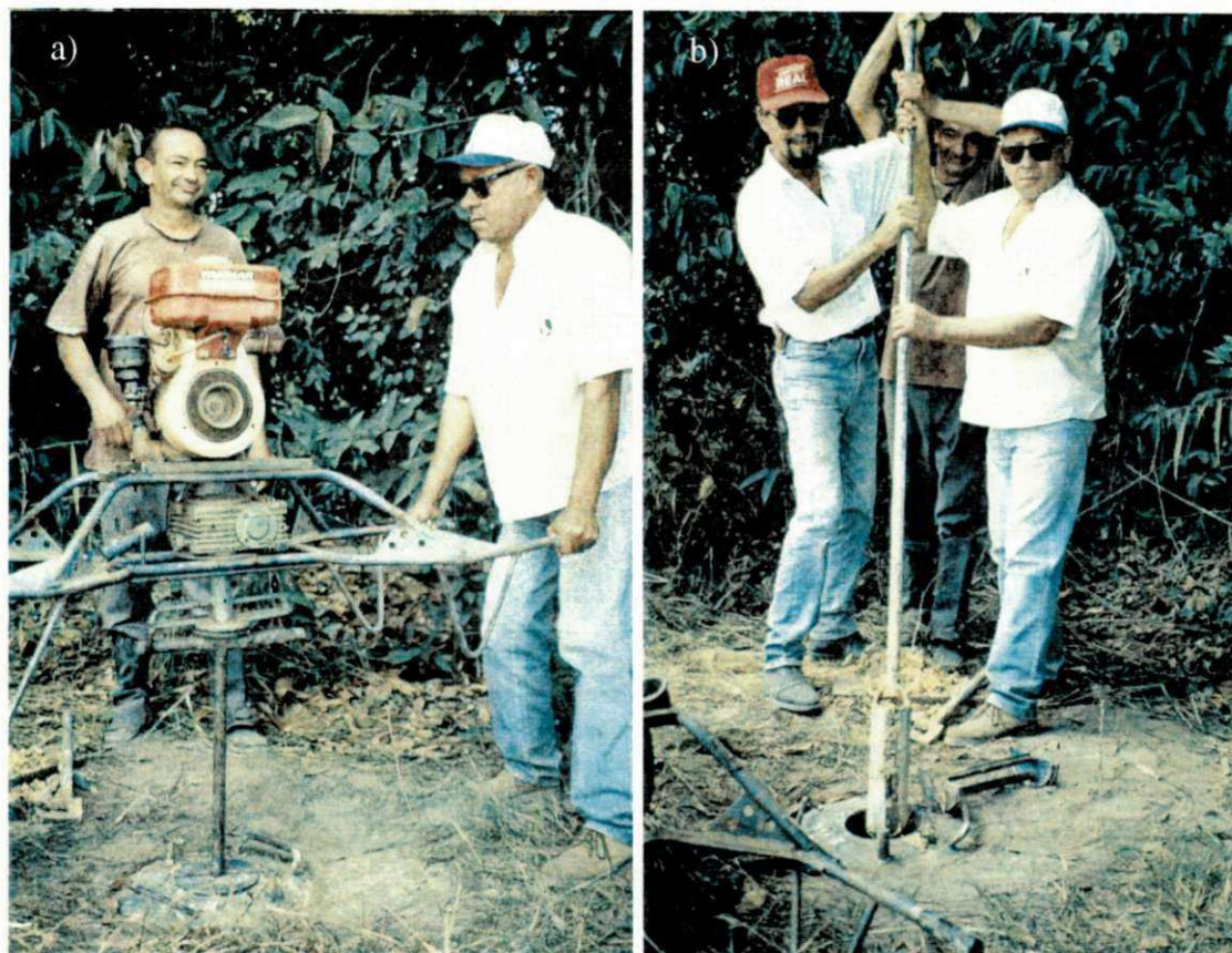
Figura 3.9 – a) Execução de furo de sondagem a trado mecânico; b) Retirada de material a partir do furo de sondagem a trado para caracterização pedológica.
