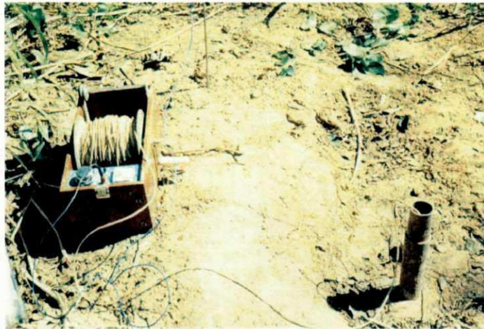
Figura 3.8 – Medidor de nível d'água elétrico utilizado nas medidas do lençol freático obtidas nos poços de monitoramento instalados dentro da área de estudo, Sorriso – MT.
