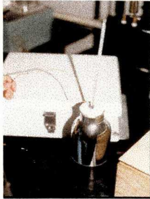
Fig. 4- 6 Dispositivo para a aferição dos termopares
