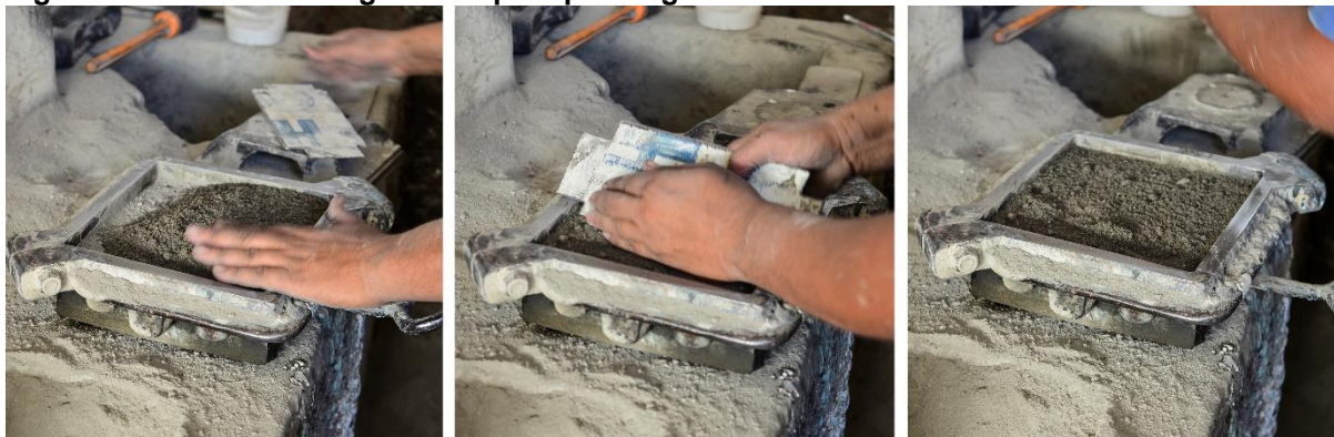
Figura 47 - Camada de argamassa para prensagem
