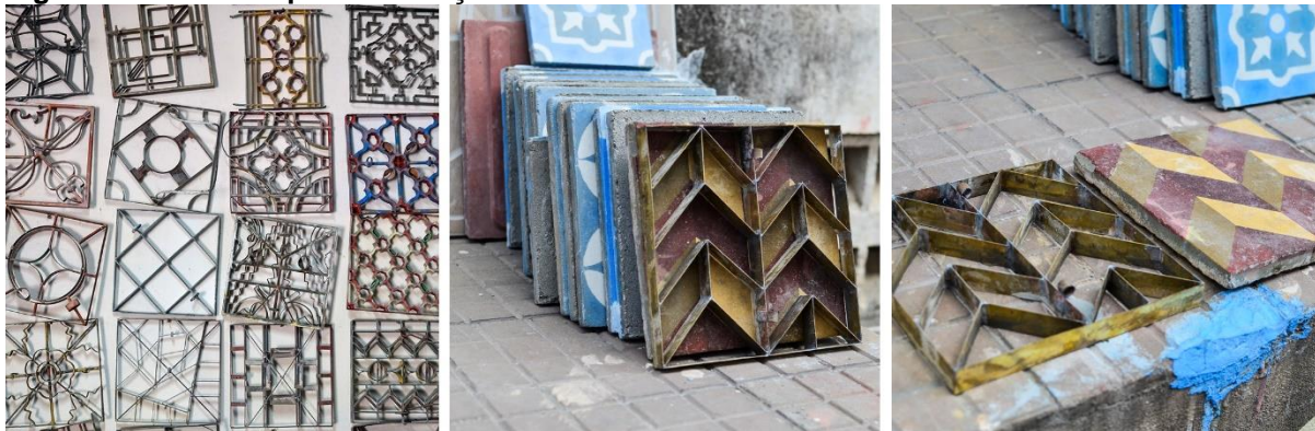
Figura 44 - Matrizes para fabricação dos ladrilhos hidráulicos
