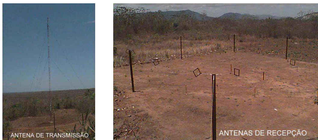
Figura 0.12 - Fotografias das antenas de transmissão e recepção da ionossonda pertencentes à unidade de Fortaleza do INPE.
