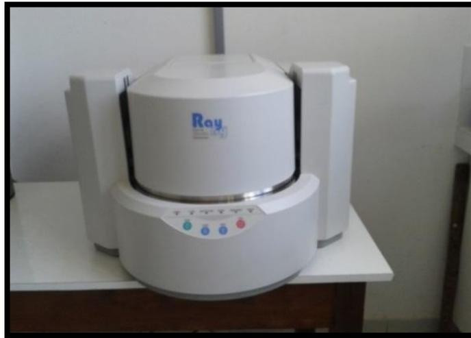
**Figura 3.3** - Espectrômetro de dispersão de raios X, modelo EDX-720
