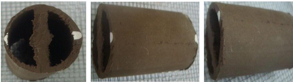
Figura 4.37 – Imagem do cilindro vazado com barra transversal no processo de secagem a 80^\circ\text{C} .
