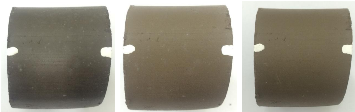
Figura 4.12 – Imagem do cilindro vazado no processo de secagem a 70°C.
