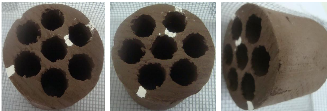
Figura 4.25 – Imagem do cilindro vazado com sete furos (tambor) no processo de secagem a 80^\circ\text{C} .
