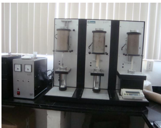
Figura 3.10 – Equipamento utilizado para análise térmica - BP Engenharia Modelo RB 3000.
