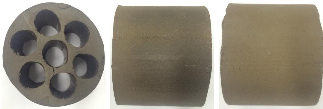
Figura 4.24 – Imagem do cilindro vazado com sete furos (tambor) no processo de secagem a 70^\circ\text{C} .
