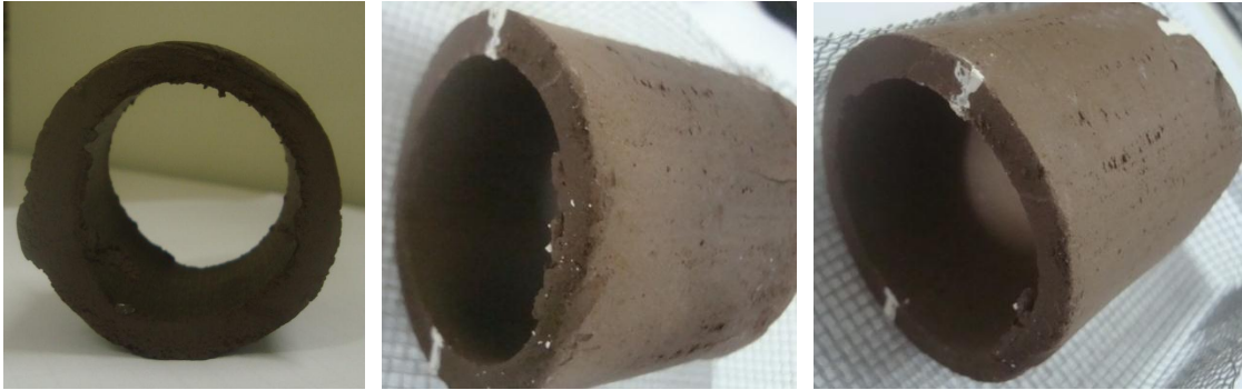
Figura 4.11 – Imagem do cilindro vazado no processo de secagem a 60°C.
