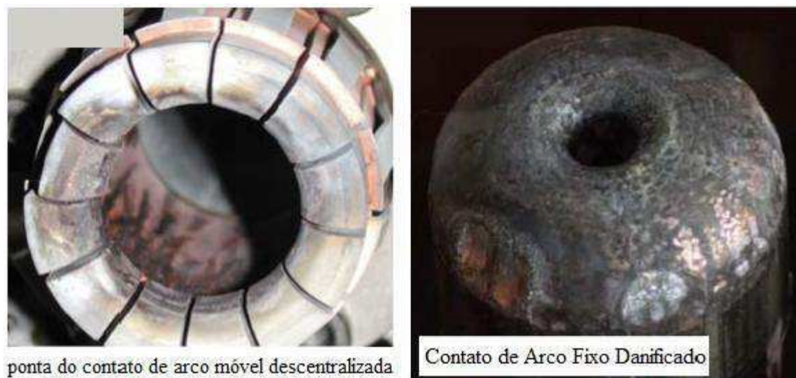
Figura 5.3: Foto dos Contatos da Câmara com Anomalia. Adaptado (LANDRY, 2006).
