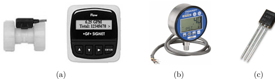
Figura 3.2 Sensores utilizados na plataforma: (a) sensor de vazão por turbinas ( Signet , mod. 2100) e o respetivo transmissor ( Signet , mod. 8550-1); (b) sensor de pressão do tipo Strain Gauge ( Ashcroft , mod. 2274 XAO); (c) sensor de temperatura do tipo semiconductor ( National Semiconductor , mod. LM35 TO-92).
