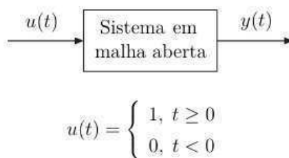
Figura 4.1 Representação em diagrama de blocos do teste com base na resposta ao degrau do sistema.
