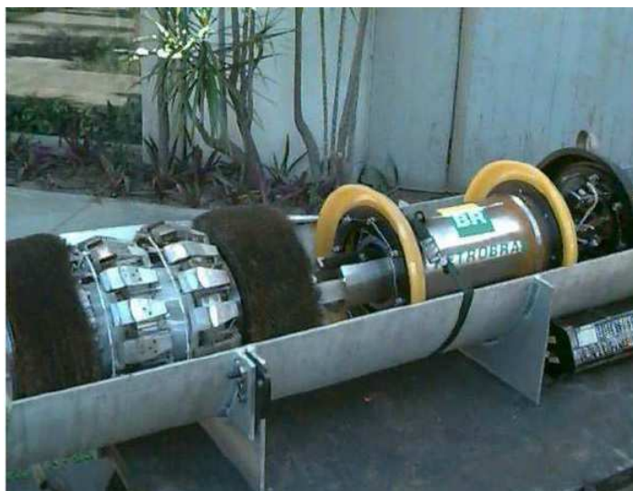
Figura 2.3 Fotografia cedida pela Petrobrás de um PIG instrumentado, para um tubo com diâmetro de 14" [2].
