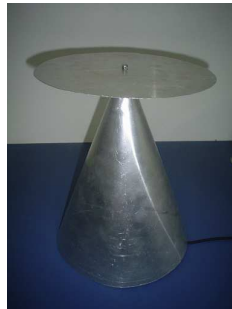
Figura 5.9: Foto do protótipo de antena construído.
