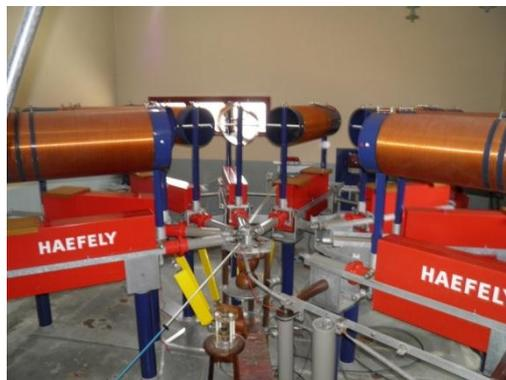
Figura 4.3: Fotografia do transformador elevador e diodo retificador utilizados nos ensaios.
