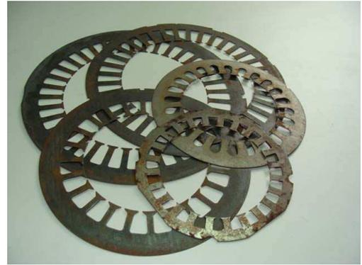
Figura 6.14: Laminação de Fe-Si
