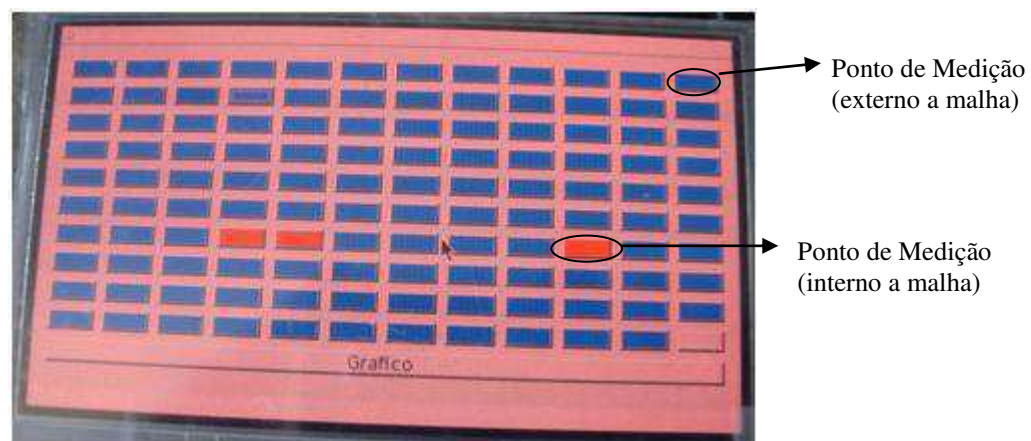
Figura3.15 – Fotografia da visualização dos pontos de medição internos e externos da malha de aterramento.
