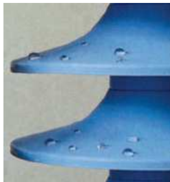
Figura 2.3 - Superfície hidrofóbica (Rodurflex, 2004b).
