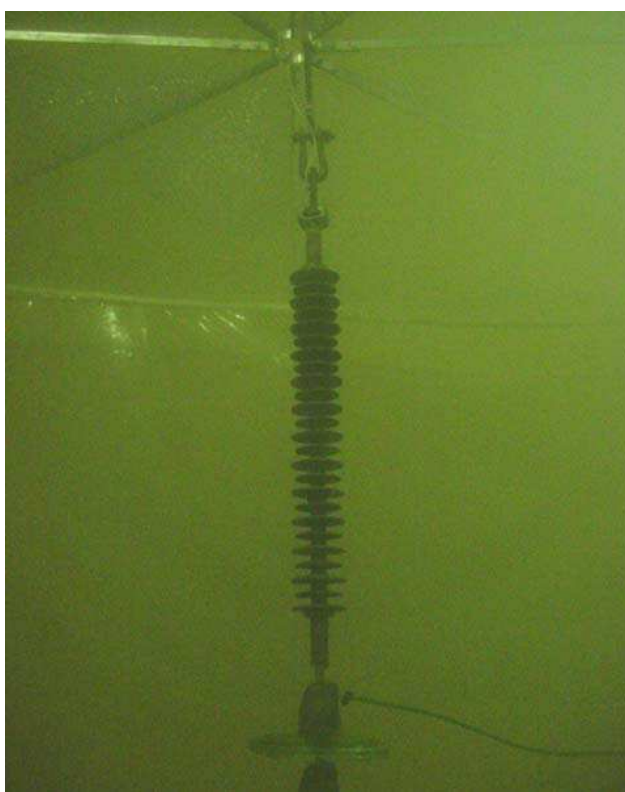
Figura 3.7 - Isolador no interior da cabine, com aplicação de névoa.
