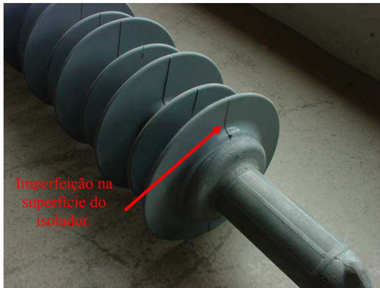
Figura 4.19 - Fotografia do isolador Tipo 2, após o termino do ensaio.
