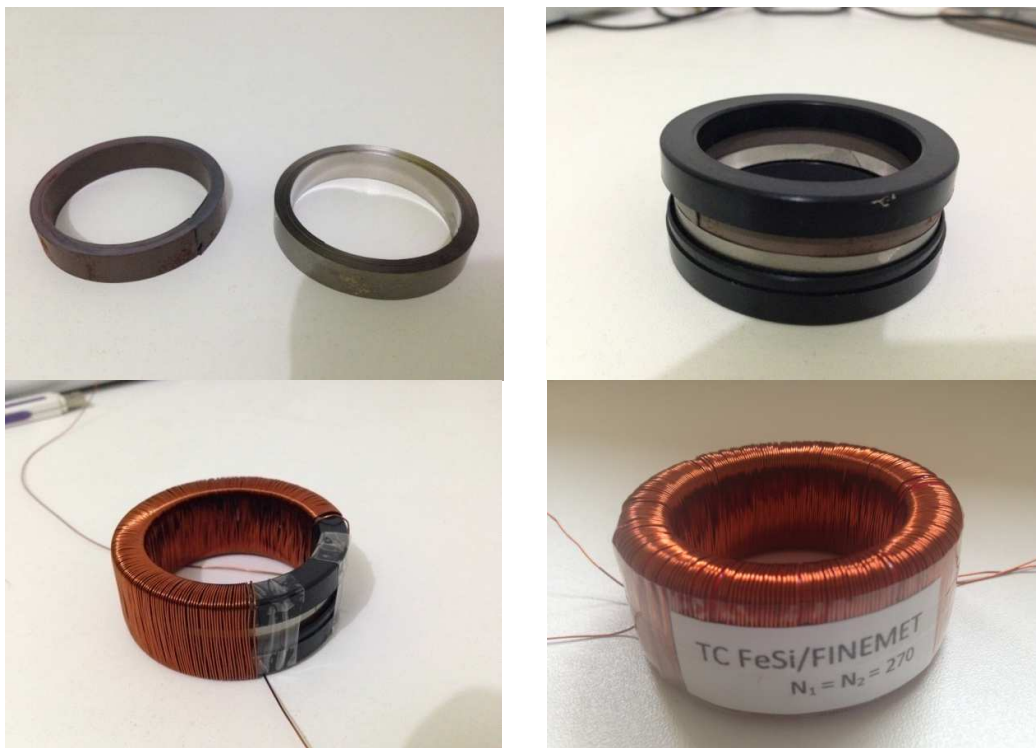
Figura 45 – Fotos da montagem do núcleo misto, composto por um núcleo de FeSi e um núcleo de liga nanocristalina FINEMET®.
