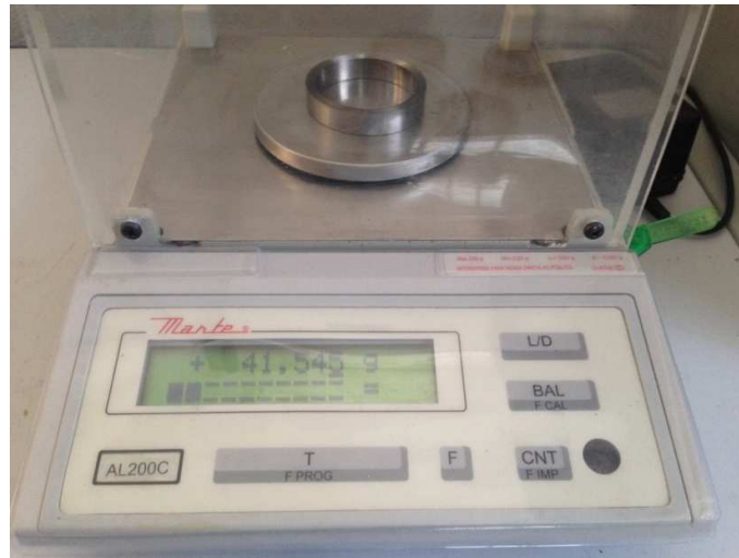
Figura 46 - Foto da medição da massa do núcleo de liga nanocristalina FINEMET®.
