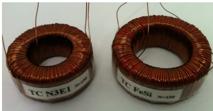
Figura 44 – Foto dos protótipos confeccionados com as ligas NANOPHY ® N3E1 e liga de FeSi GO.
