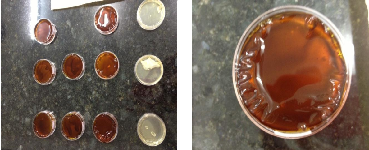
Figura 22 - Processo de neutralização com NaOH das membranas do tipo B.
