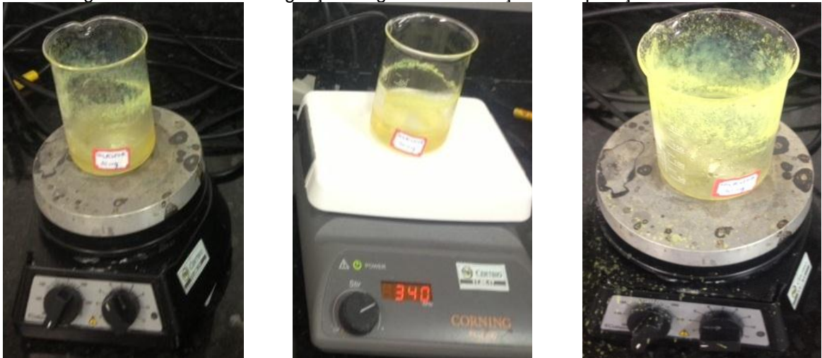
Figura 26 - Processo de agitação magnética da solução e evaporação do metanol.
