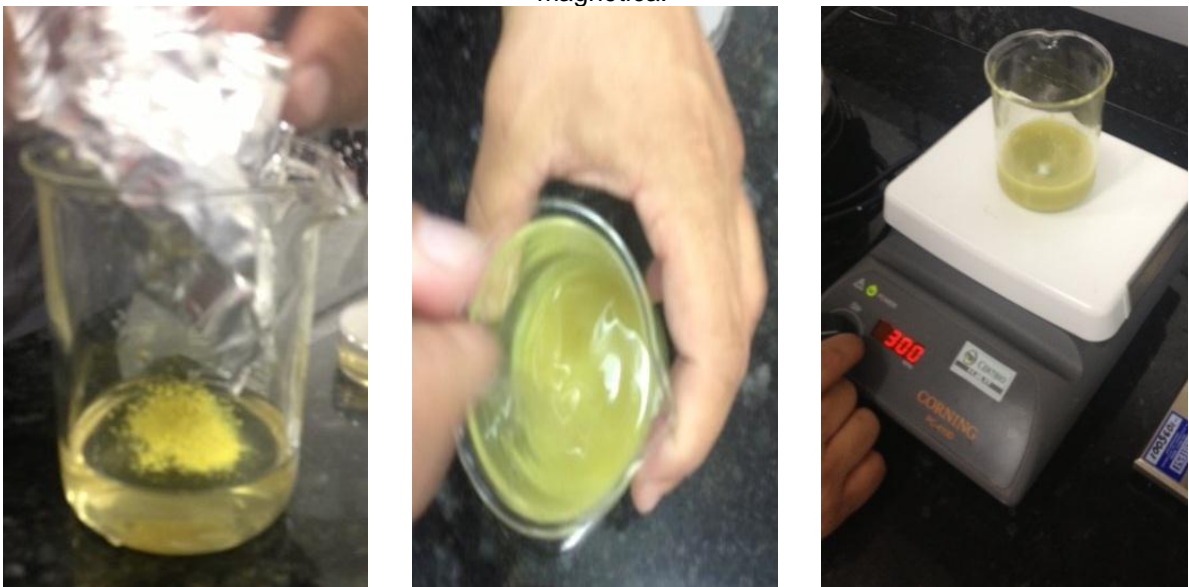
Figura 18 - Adição da quercetina na solução de quitosana neutralizada, seguida da agitação magnética.
