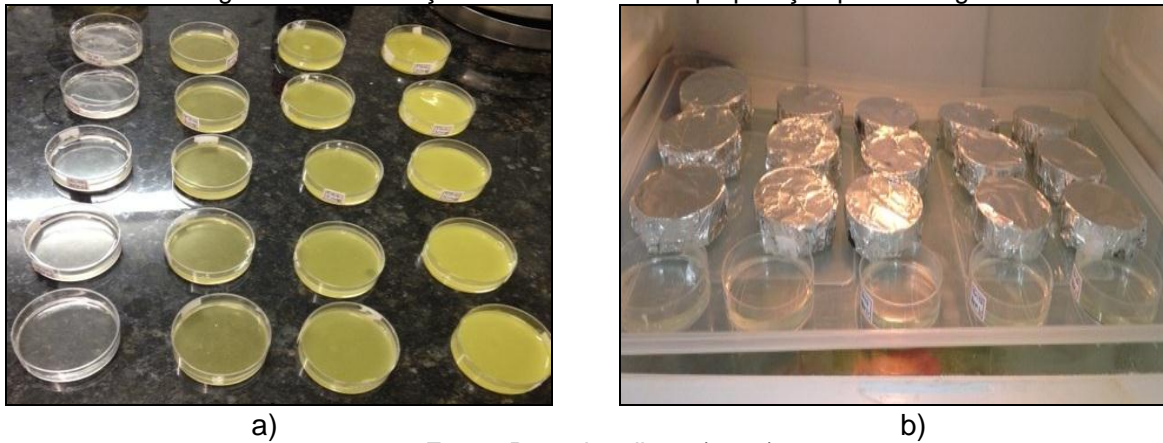
Figura 64 - Finalização das membranas e preparação para secagem.
