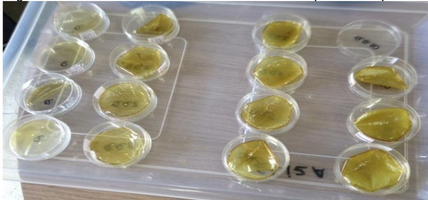
Figura 68 - Imersão das membranas em TPP e etapas subsequentes.
