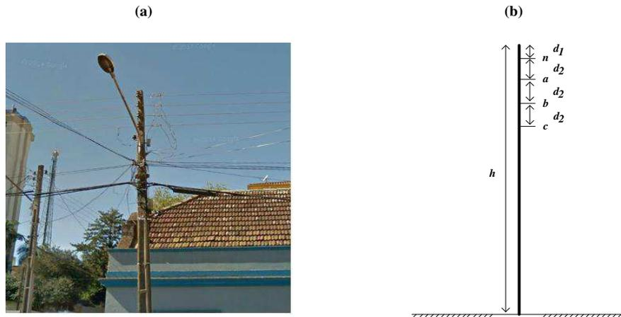
Figura 6.5. Configuração da conexão dos cabos nos postes: (a) fotografia e (b) representação esquemática.
