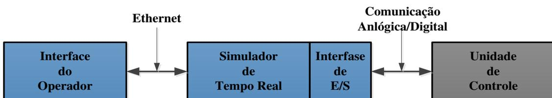
Figura 1.4. Arquitetura básica de uma simulação HIL.
