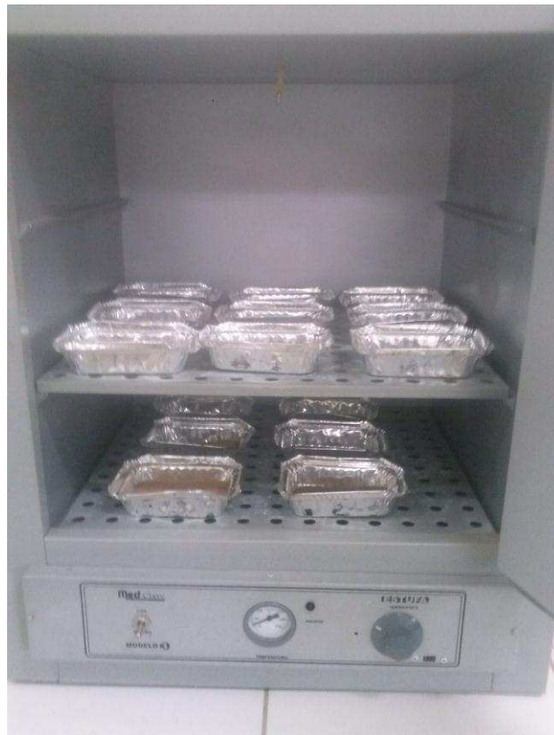
Figura 05: Secagem das amostras de solo na estufa a 60°C
