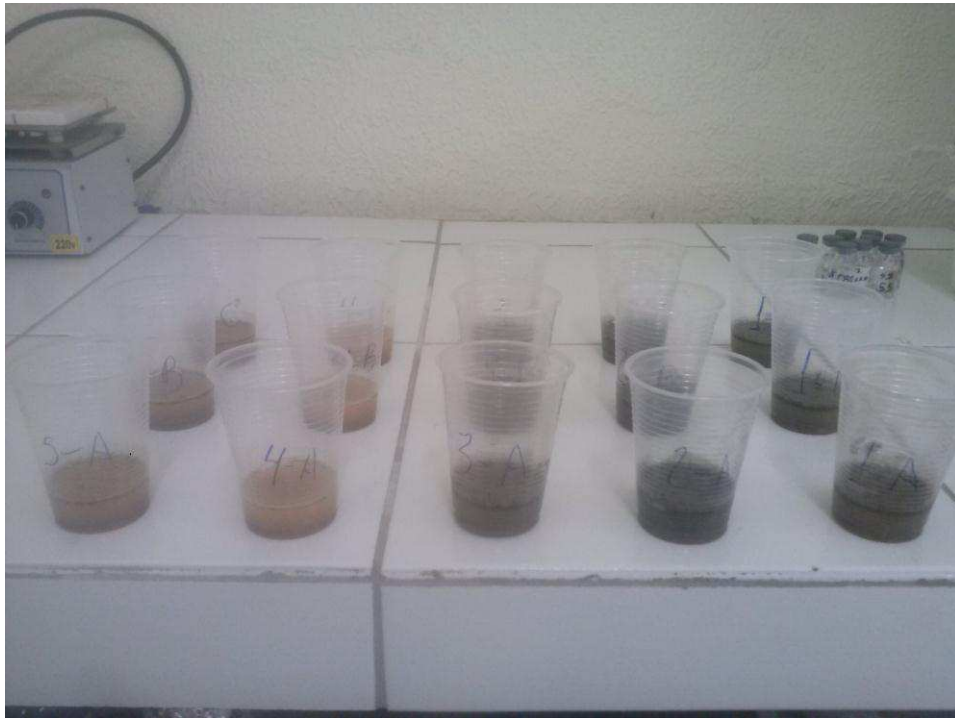
Figura 10: Amostras de solo em solução com H 2 O para determinação do pH
