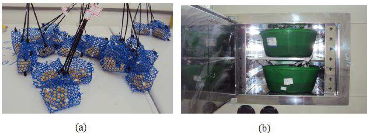
Figura 3.30: (a) Cestas teladas; (b) Recipientes na estufa com as cestas imersas na solução osmótica.
