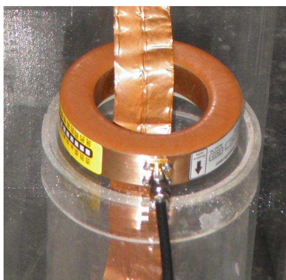
Figura 5.5 - Transformador de corrente de altas frequências.
