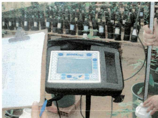
Figura 3. Monitoramento da água disponível com uso da sonda segmentada de DIVINNER – 2000 e o leitor do equipamento em destaque
