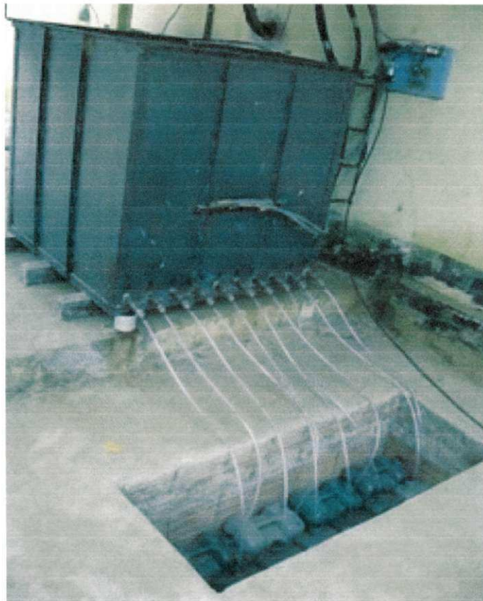
Figura 5 - Detalhe do sistema de drenagem do lisímetro e dos coletores.
