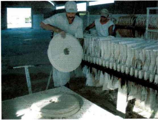
Beneficiamento do Caulim na forma de torta prensada e secagem ao sol
