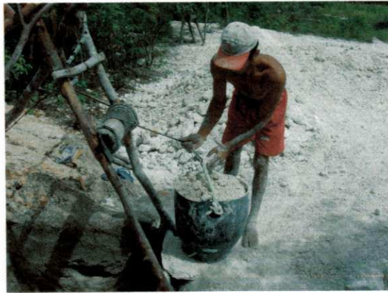
Localidade da Carneira, vista da banqueta I e sistema de retirada do Caulim
