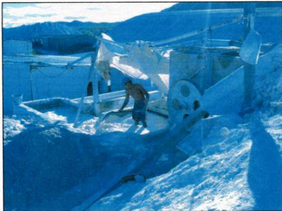
Beneficiamento do Caulim na fase de desagregação e separação por telas.
