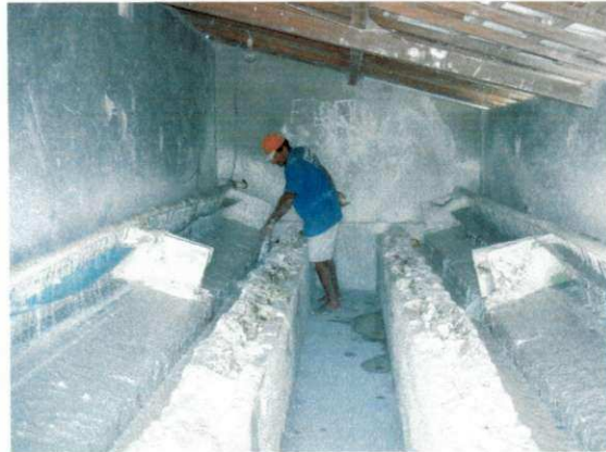
Beneficiamento do Caulim na fase de desagregação e separação por telas.
