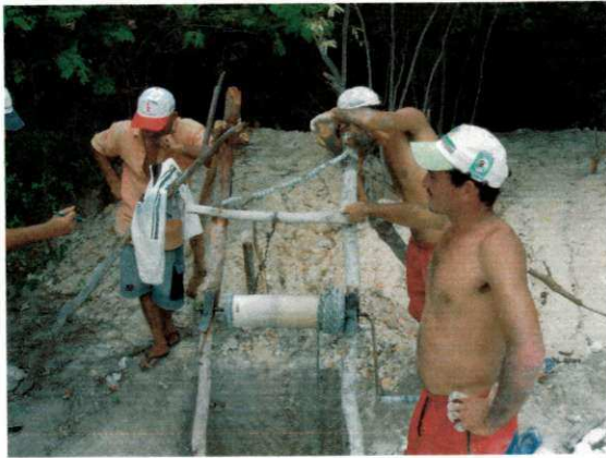
Localidade da Carneira, vista da banqueta I e sistema de retirada do Caulim
