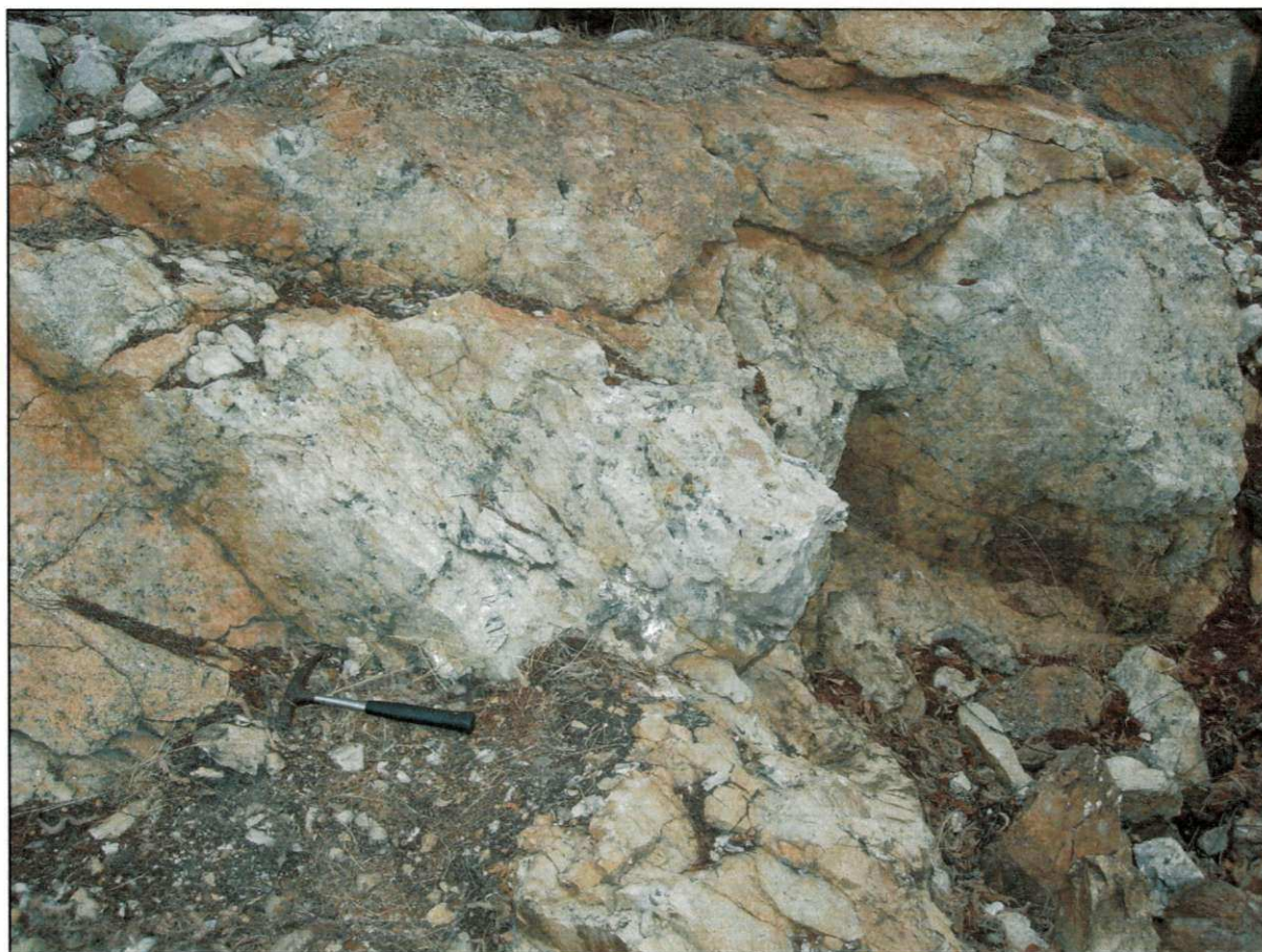
Figura 36 – Características das descontinuidades do granito gráfico (Pegmatito do Daniel – Jardim do Seridó – RN)
