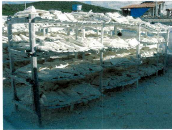
Beneficiamento do Caulim na forma de torta prensada e secagem ao sol
