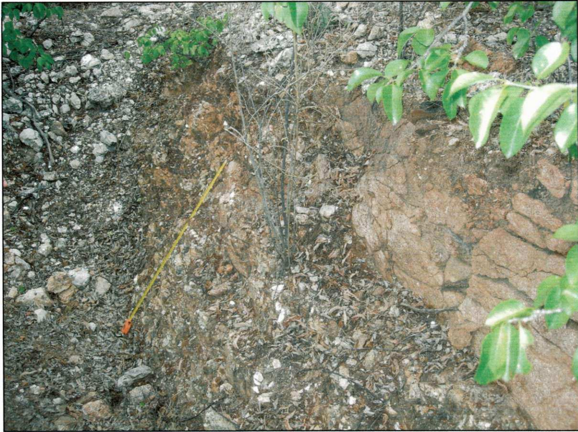
Figura 34 – Características das descontinuidades do micaxisto (Pegmatito do Daniel – Jardim do Seridó –RN)
