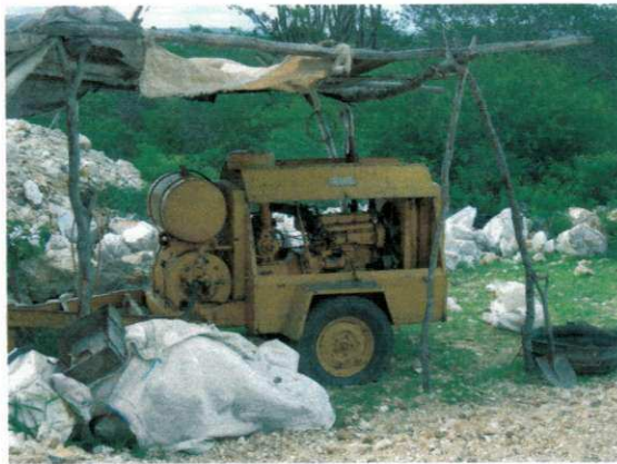
Alto da Situação, abertura de banqueta e compressor utilizado na perfuração de rocha.
