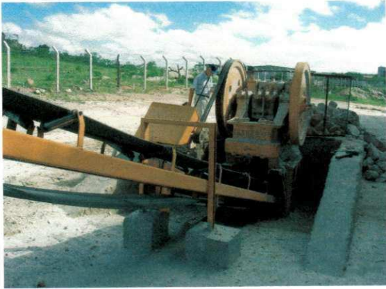
Luzarte Estrela Ltda., britagem primária e pilha de feldspato moído.
