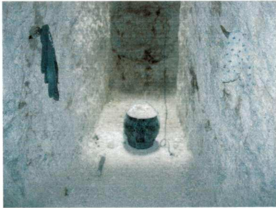
Localidade da Carneira, estrutura interna da banqueta e rocha encaixante do Caulim
