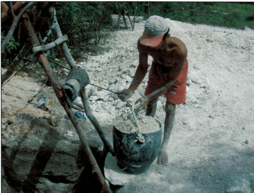
Figura 13 – Sistema de retirada de caulim, Junco do Seridó/PB
