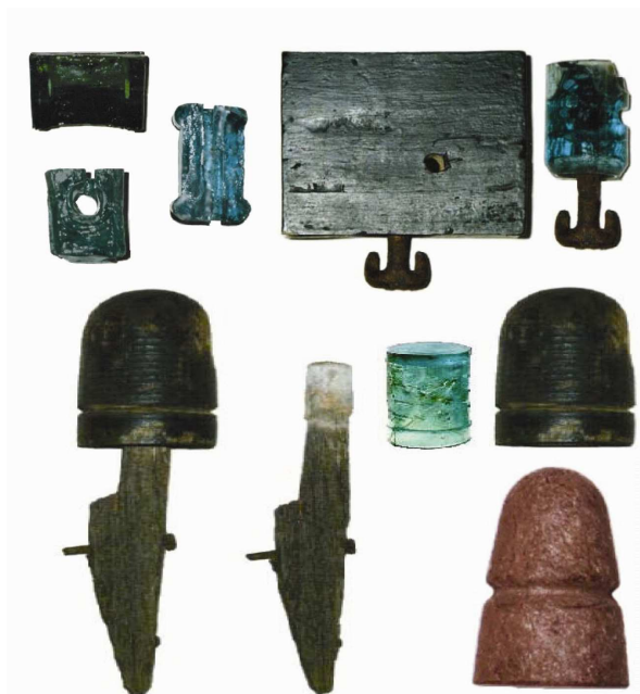
Figura 1. Modelos antigos de isoladores cerâmicos (Janssen, 2005).
