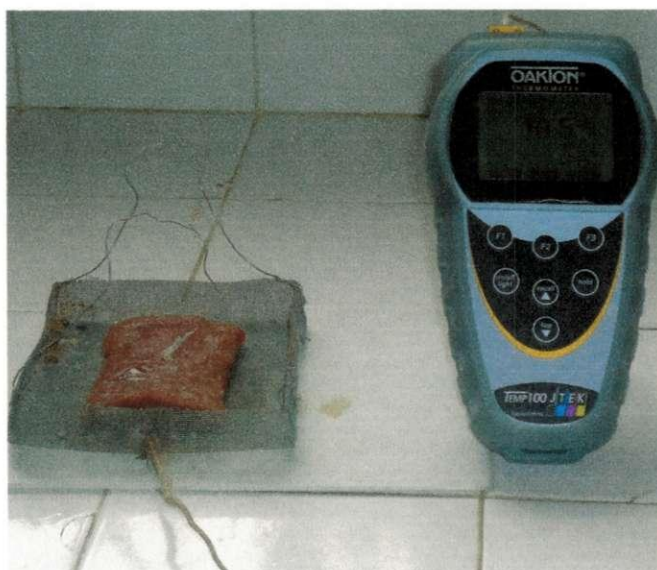
Figura 3.2 – Amostra, cesta de arame, termopar e medidor de temperatura, para realização da cinética de congelamento
