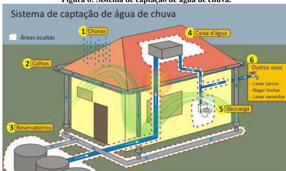
Figura 6: Sistema de captação de água de chuva.
