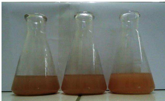
Figura 22: Titulação com \text{AgNO}_3 , 0,1 \text{ mol.L}^{-1}
