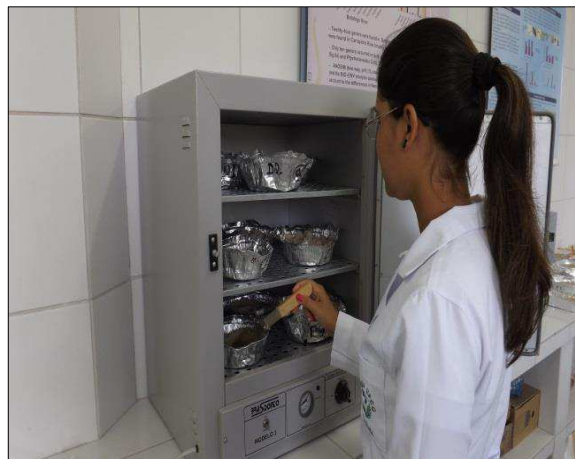
Figura 17 – Sedimento em recipientes de alumínio na estufa para secagem.
