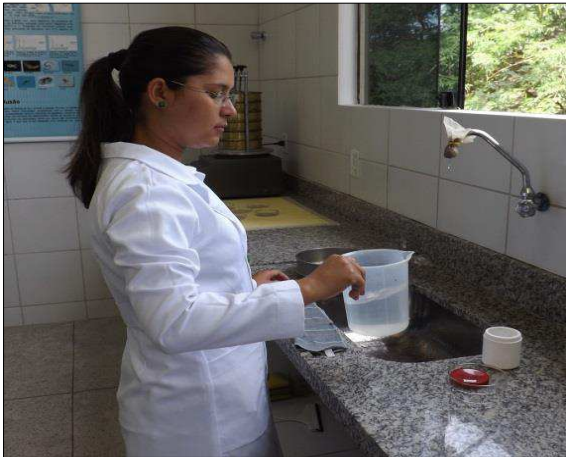
Figura 6 – Processo de elutriação manual.
