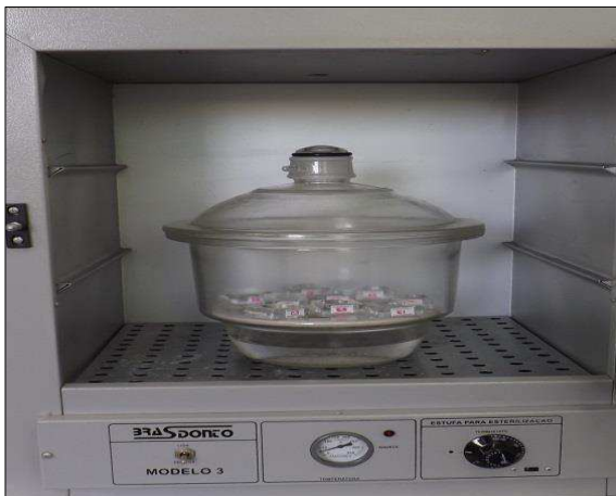
Figura 10 – Cadinhos identificados contendo amostras dentro do dissecador.
