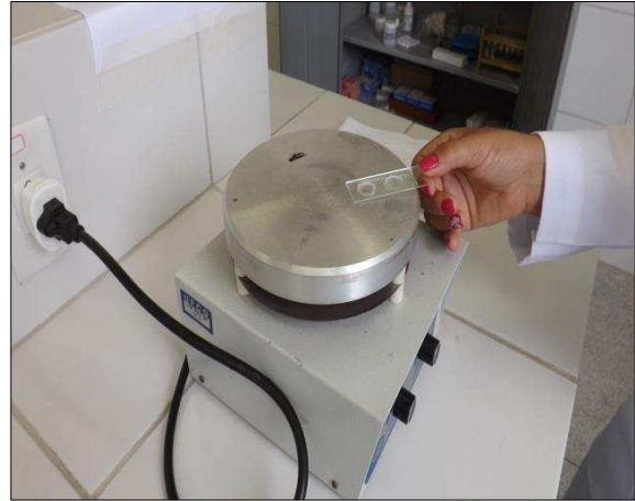
Figura 13 – Lâmina marcada com parafina no aquecedor para fixação da lamínula.
