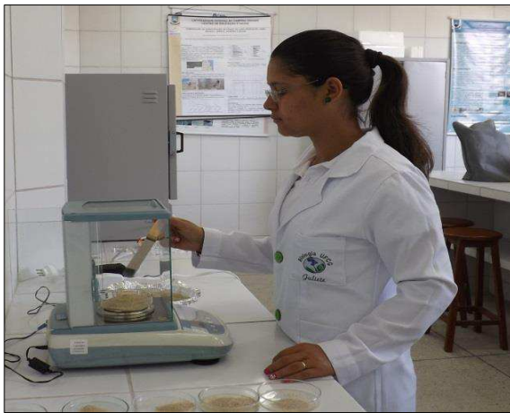
Figura 18 – Pesagem do sedimento na balança de precisão.
