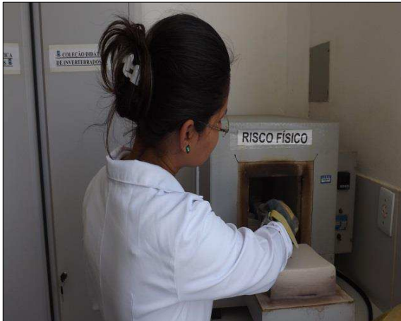
Figura 20 – Cadinhos inseridos na mulfa para volatilização da matéria orgânica.
