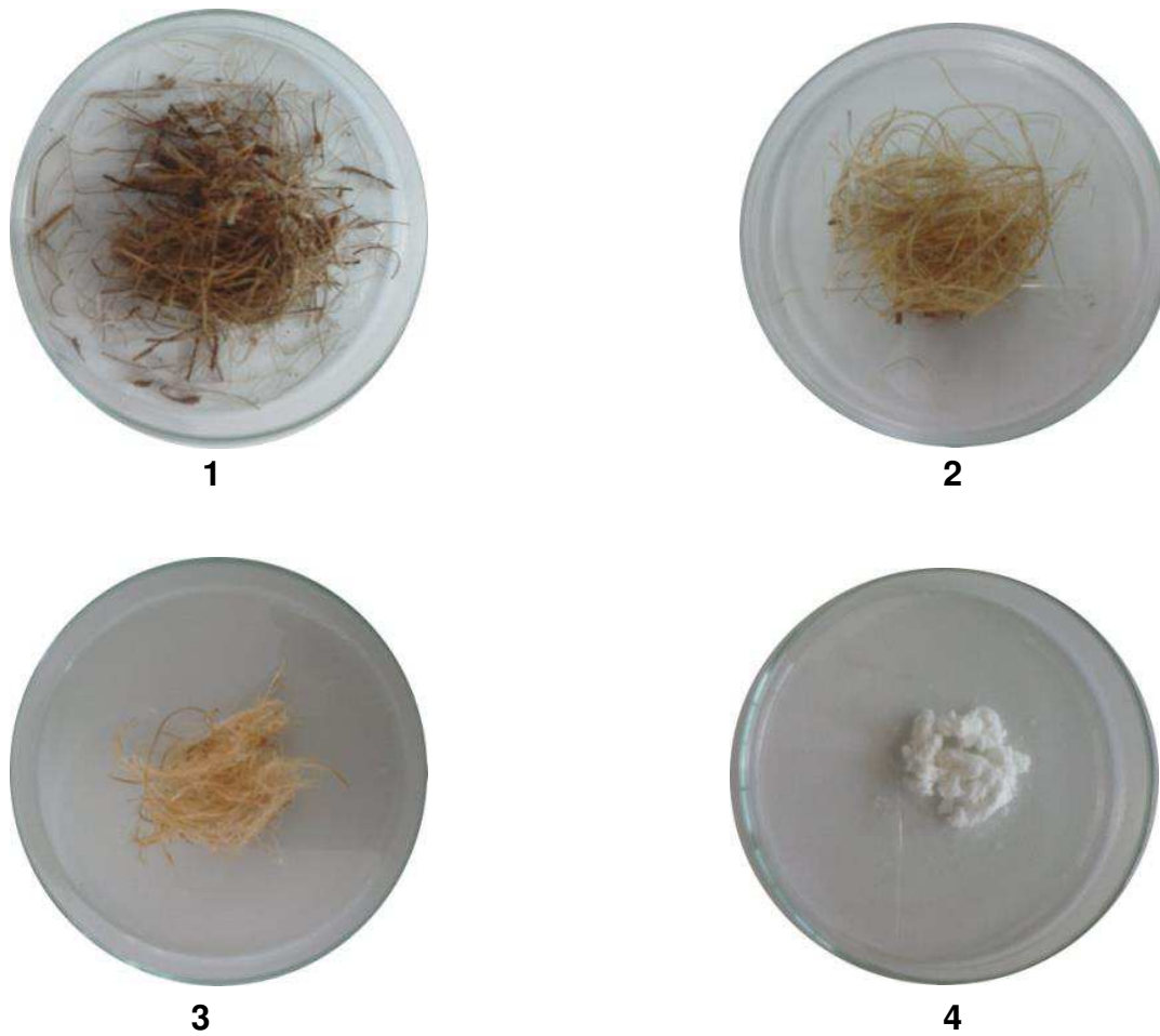
Figura 25. Etapas da extração de celulose da fibra do coco seco. 1 Fibra com hipoclorito 3%, 2 Clorito de Sódio 0,3M, 3 NaOH 4M (frio), 4 NaOH 4M (quente).
