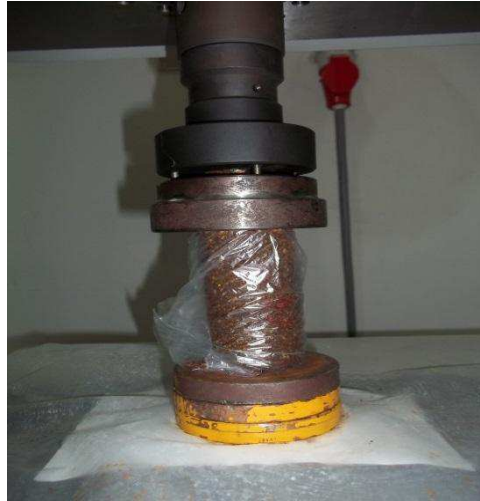
Apêndice 3 bloco sendo prensado para determinação de dureza e resistência
