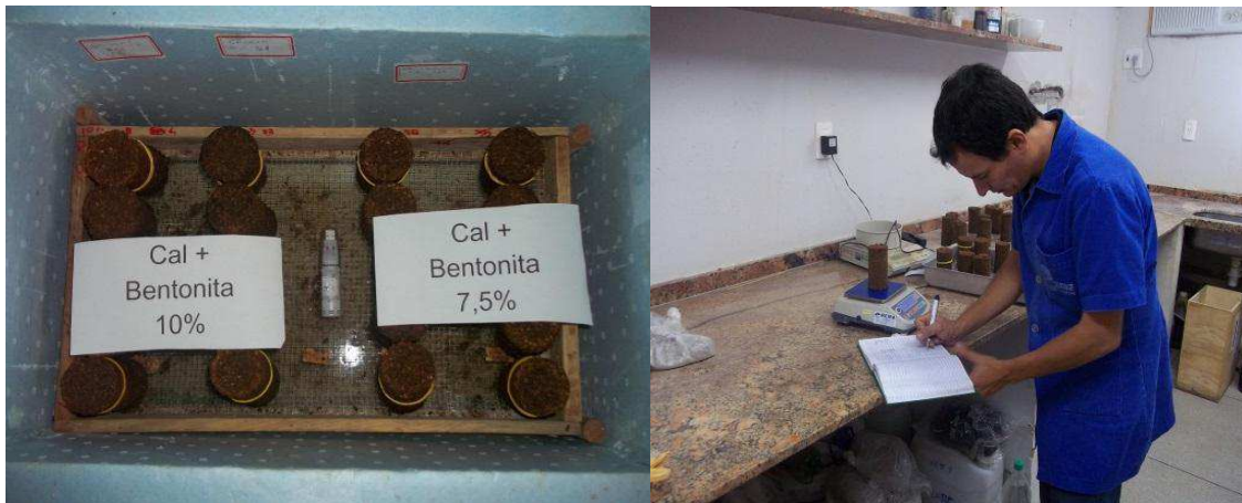
Apêndice 4 Procedimento para calcular absorção de água, (direita: corpos de prova na caixa para absorção da água; Esquerda pesagem)
