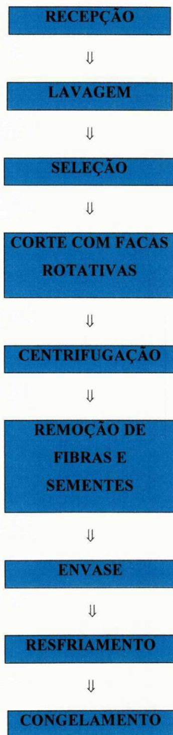
Figura 3- Fluxograma de processamento de suco de maracujá descrito por Chan e citado por SALUNKHE e DESAI (1984).
