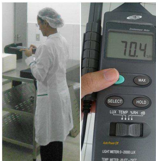
Figura 4 – Aferição da umidade do Restaurante Universitário/CES
