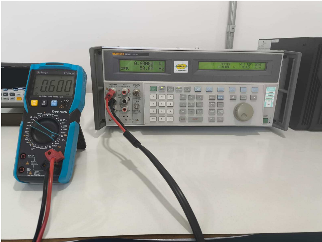
Figura 1: Montagem realizada em laboratório para a calibração. Fonte: Próprio autor.
