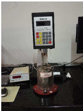
Figura 12: Viscosímetro do tipo Brookfield.
