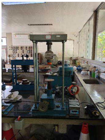
Figura 23: Equipamento para ensaio de RT.
