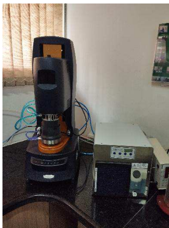
Figura 15: Equipamentos para ensaio de MSCR.
