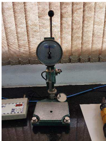
Figura 11: Penetrômetro para ensaio de Penetração.
