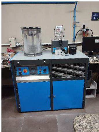
Figura 25: AMPT para ensaio de Flow Number .
