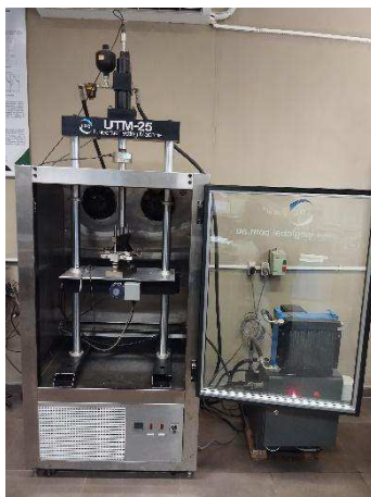
Figura 24: UTM para o ensaio de Módulo de Resiliência.
