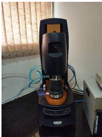
Figura 14: Reômetro para o ensaio de PG.
