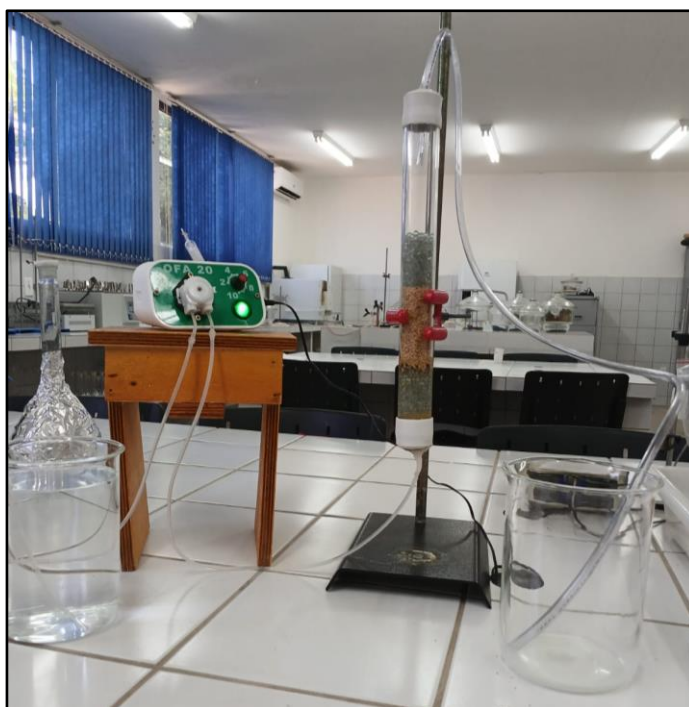
Figura 9- Ensaio de adsorção com leito adsorvente de 7,5 cm
