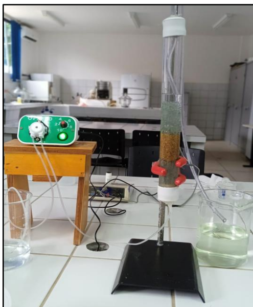
Figura 8- Ensaio de adsorção com leito adsorvente de 5 cm
