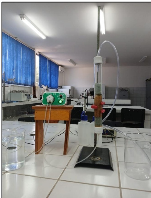
Figura 10- Ensaio de adsorção com leito adsorvente de 10 cm
