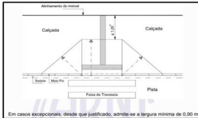
Ilustração 5-Rebaixamento de calçada – vista superior
